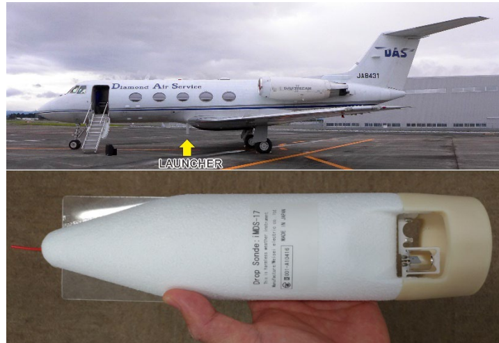
図1 (上) 台風観測に使用した小型ジェット機「ガルフストリーム II」 (下) ジェット機から投下するドロップゾンデ。降下中に気圧、気温、湿度、 風向、風速を1秒間隔で測定し、データをラジオ電波でジェット機に送信する
